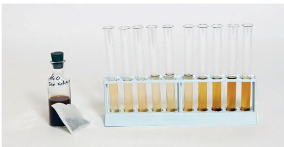
Extraktion mit kaltem Ethanol ( $C_2H_6O$ )
