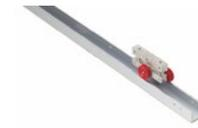
Die verwindungsfreie Alu-Schiene dient als Fahrbahn für verschiedene Experimente zu Kraft, Masse, Geschwindigkeit und Beschleunigung. Durch ihre Stahlaufgabe wird die Schiene auch als optische Bank zur Befestigung der magnethaftenden Bauteile aus der KISAM-Box 7 verwendet.
