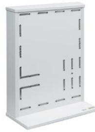
Die solide Experimentier-Grundplatte ist mit 47 Buchsen (Ø 4 mm) bestückt. Sie kann stehend, auf dem Rücken liegend oder auf die Seite gekippt eingesetzt werden. Die rostfreien Verbindungsstege sind elektrisch leitend.
