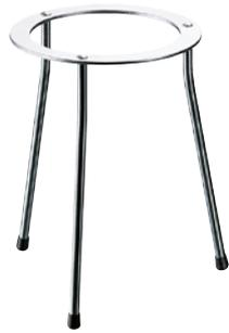
Das Dreibein wird zusammen mit dem Butangasbrenner und dem keramikbeschichteten Drahtgewebe beim Erhitzen von Bechergläsern, Erlenmeyerkolben und Abdampfschalen verwendet. Es besteht aus verzinktem Stahl.
