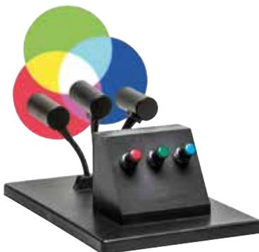
**Gerät zur additiven Farbmischung**
