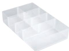
Compartiment avec 7 casiers, sans bordure, dimensions extérieures: largeur 212 mm, longueur 342 mm, hauteur 68 mm, dimensions intérieures: 6 casiers de 104 x 71 mm, 1 casier de 208 x 115 mm. Adapté aux caisses en plastique no 06.55.004, 06.55.009, 06.55.022.
